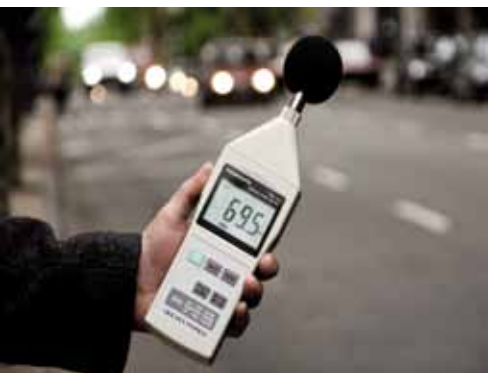
Sonómetro: mide el nivel de ruido que existe en determinado lugar y en un momento dado provocado por los vehículos.
