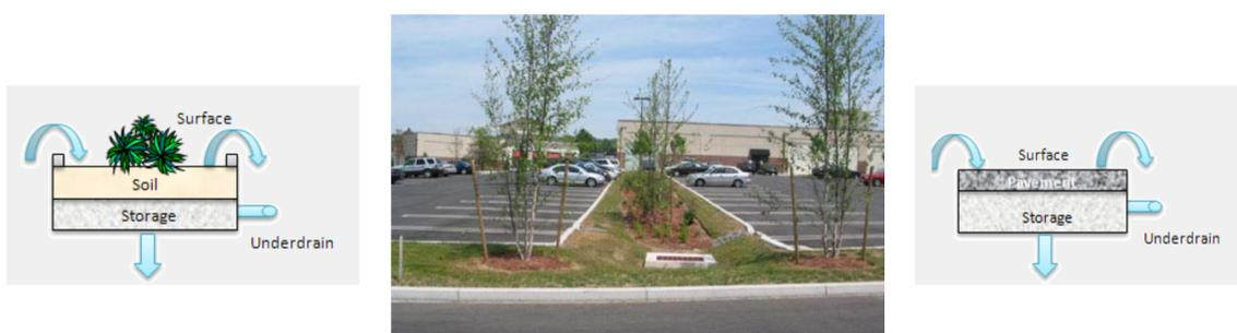
FIGURA 1 EJEMPLO DE MEDIDA DE CONTROL DE ESCURRIMIENTO, ESQUEMAS DE LAS HERRAMIENTAS LID DE SWMM
