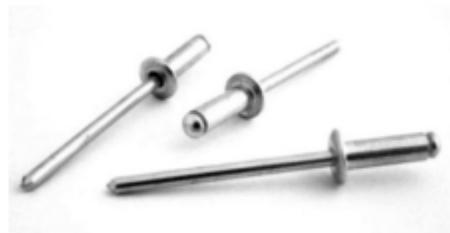
El remache corriente, es un método de unión y fijación popular, debido a su simplicidad, bajo costo y confiabilidad. El remache pesado, se emplea para estructuras de puentes y edificios. Aunque los pernos de alta resistencia casi han reemplazado a los remaches para las conexiones en la obra.
