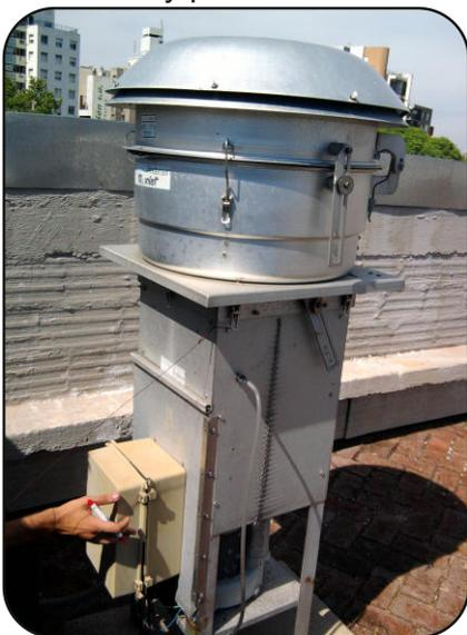
Ilustración 1.1 Hi Vol configurado para PM10
