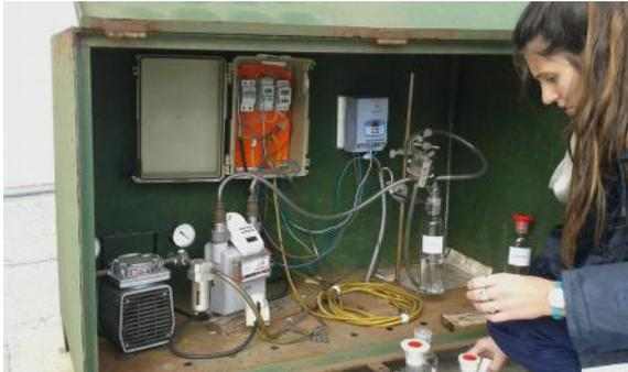
*Ilustración 1.4: Tren de Monitoreo para la determinación de Humo Negro y SO<sub>2</sub>*
