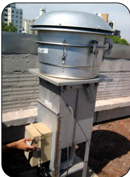
Ilustración 1.1 Hi Vol configurado para PM<sub>10</sub>
