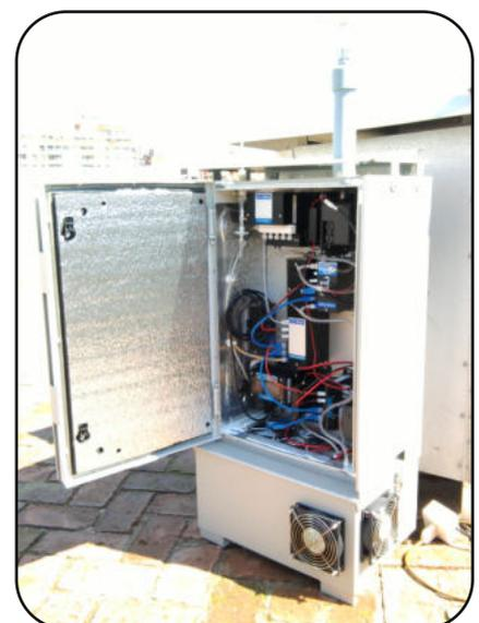
Ilustración 1.3 Equipo Automático de Material Particulado Lightscattering
