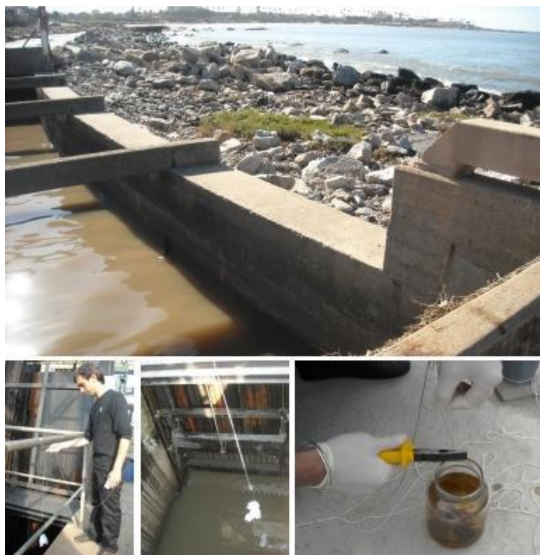
Figura 8.2. Colocación de y retiro de hisopo de Moore en aliviaderos del sistema de saneamiento.
