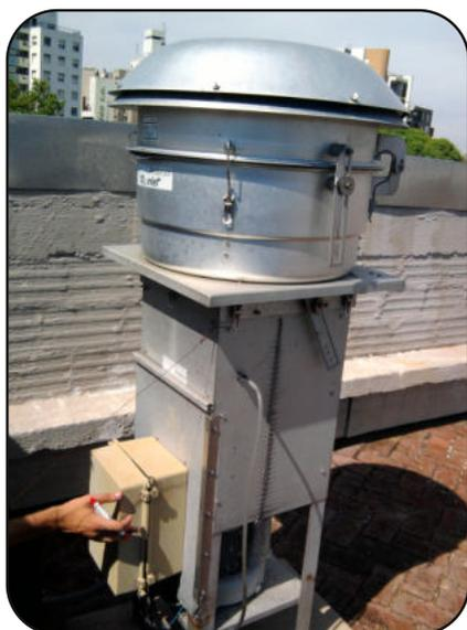
Ilustración 1.1 Hi Vol configurado para PM10
