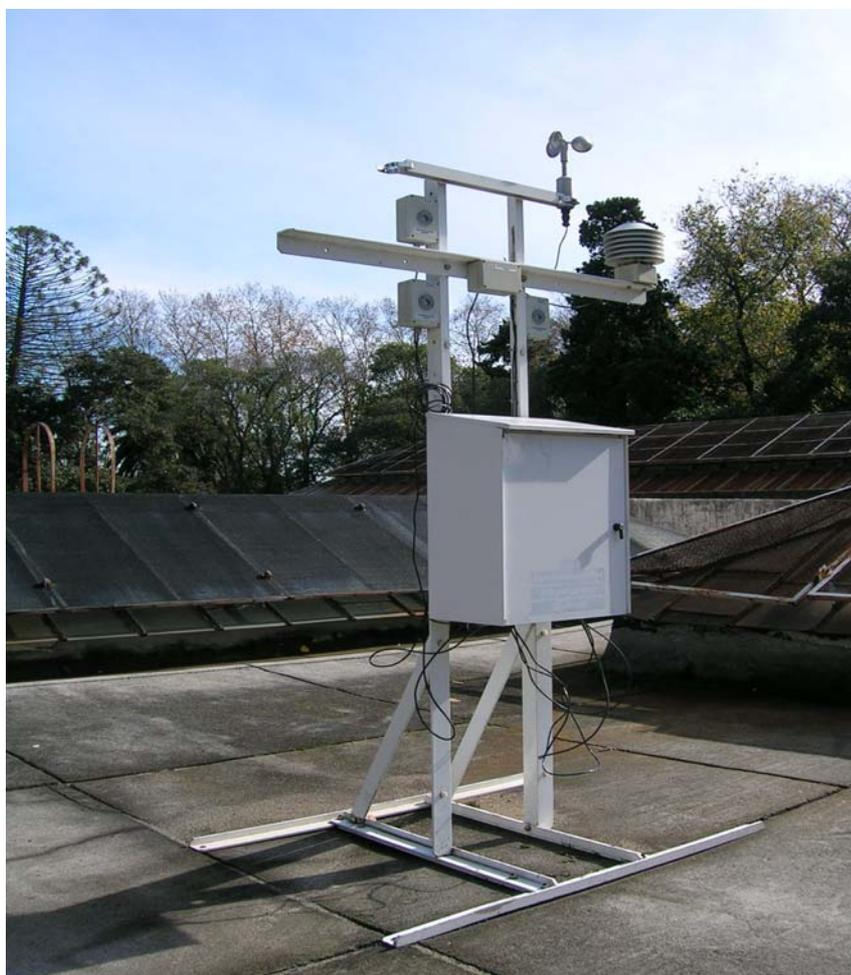
Estación automática de monitoreo de gases con sensores selectivos
